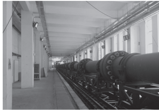
● 그림 7 ● 좌) CAS JF12 (2012; Mach 수 5~9, 고도 25~50km, 130 millisec); 우) 중국 CAAA FD21 (2016; Mach 수 10~15, 50 millisec, 세계 최대)[26]
