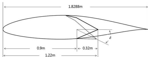
그림 1. NACA 65(1)212 익형 모델 형상
